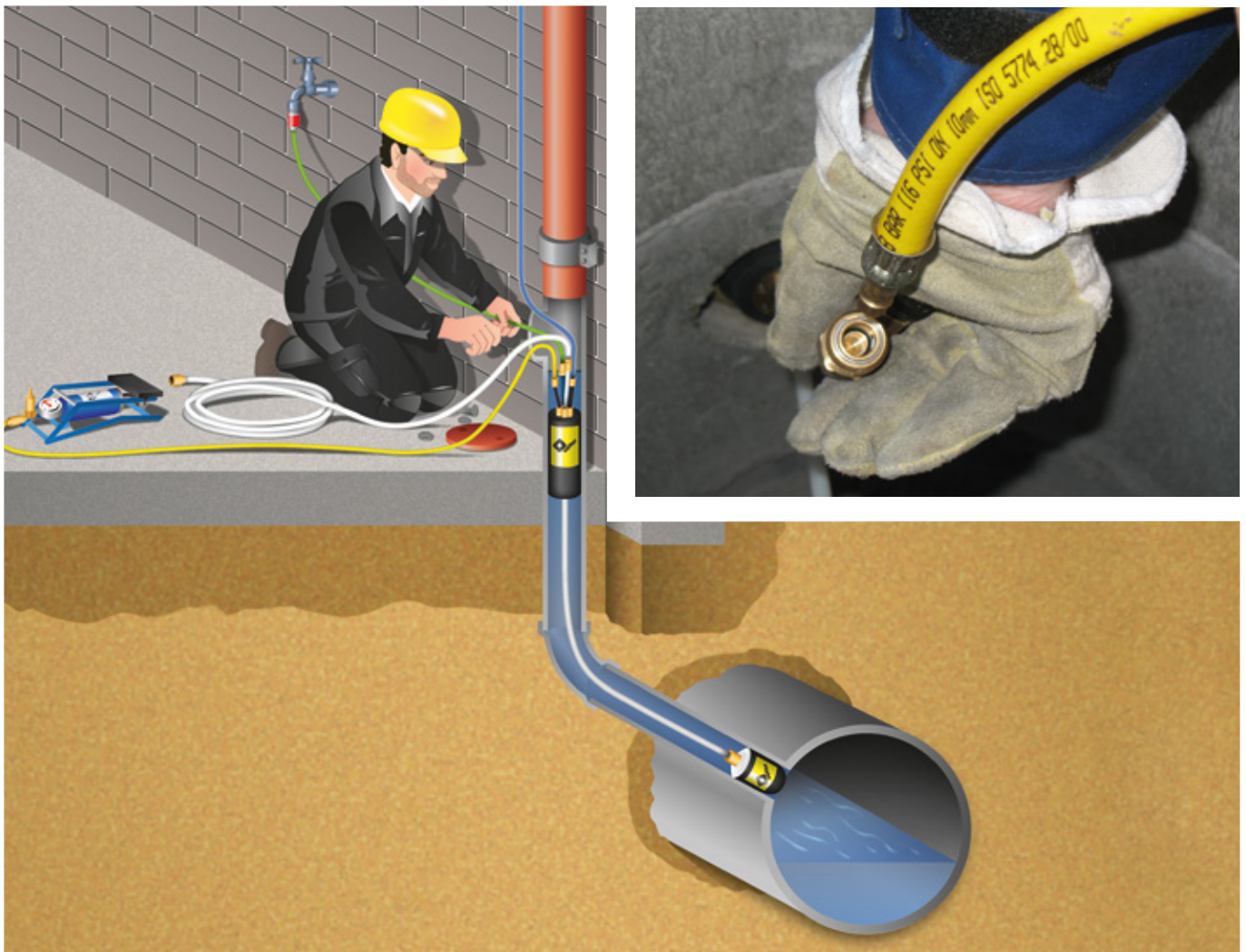
Wasserdruckprüfung gemäß DIN EN 1610 mit dem Vetter Hausanschlussprüfsystem
